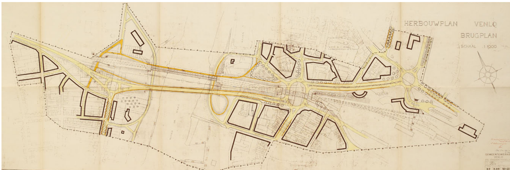
Het Brugplan uit 1951 is een aaneenschakeling van verkeerspleinen, boulevards en viaducten met gescheiden verkeerstromen voor trein, auto en fiets (G.A. Venlo).
